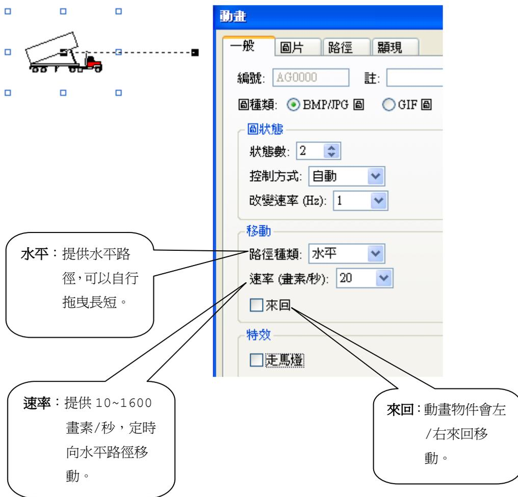
**水平**：提供水平路徑，可以自行拖曳長短。
