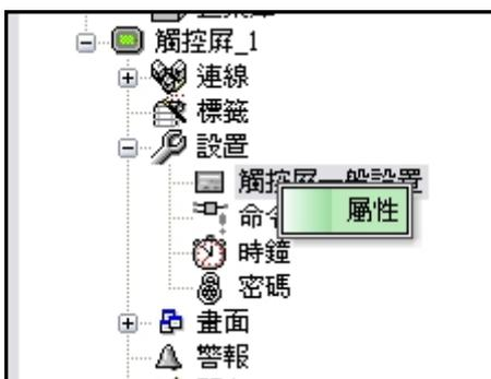
先用滑鼠點選在觸控屏\_1 下方的\_一般設置，再按滑鼠右鍵，出現並點擊\_屬性，就可以進行設置。一個觸控屏基本上需要設置一些必要參數，以便於觸控屏在運行後能有效地去執行各項任務，並可方便所連接的控制器能與觸控屏進行程序同步工作。
