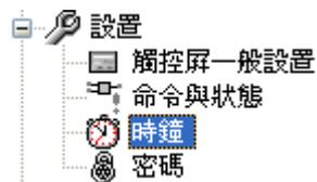
在觸控屏中有內建的系統萬年曆，使用者可以將此數據寫入控制器，提供給 PLC 本身沒有萬年曆的時候就可以利用觸控屏來提供，另一種情況是有些控制器本身也有萬年曆，所以爲了將 PLC 和觸控屏兩者的萬年曆達到同步化，就可以採用定時同步或觸發同步。例如時鐘設置就可以讓觸控屏將內部時鐘寫入控制器進行時序操作控制，也可以設置讓控制器的時鐘與觸控屏的時鐘定時同步對時，以確定所進行的操作和監視狀態的時間是同步的。
