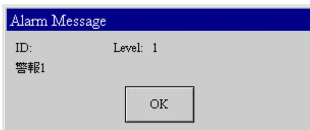
**顯示視窗畫面：**當 PLC 相對 Bit 資料 On 時，顯示指定的視窗畫面；如有多個警報同時發生時，觸控屏會依優先顯示等級，顯示所有的視窗畫面。
