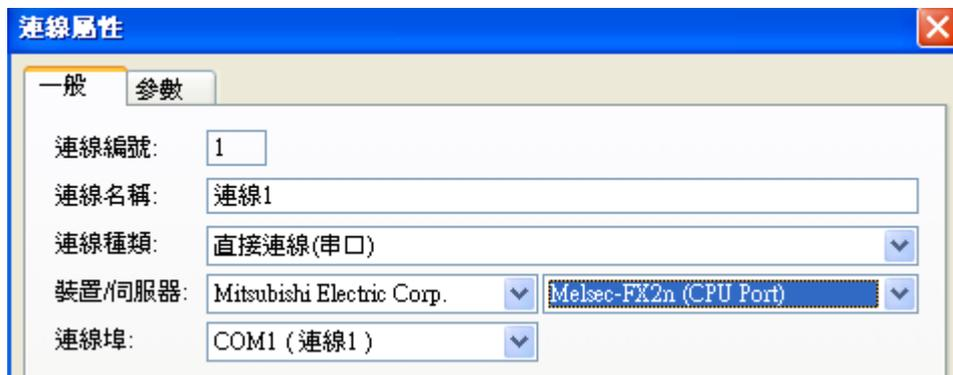
第一台觸控屏\_連線 2，選擇要連線的方式，通訊服務(串口)\_2-to-1 Server。
