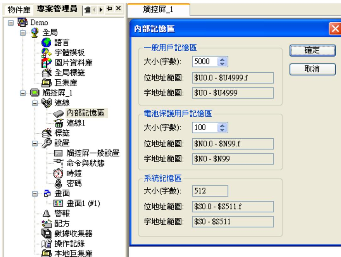
在觸控屏硬體設計上內部提供有一般用戶記憶區，電池保護用戶記憶區，和系統記憶區等幾個內存區，這些內部記憶區可以提供給設計師在規劃物件資料時使用，可以當作巨集指令運算內存使用，也可以當作觸控屏系統命令區和狀態區。
