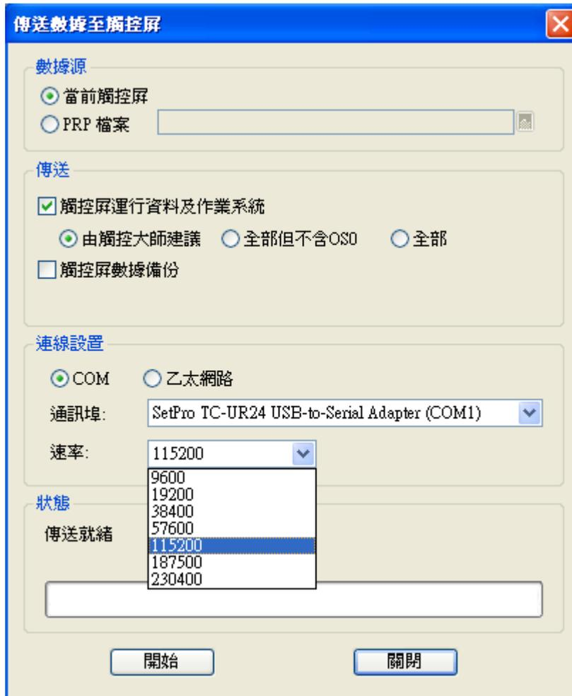
圖 2-71 觸控屏設置欄\_傳送數據至觸控屏之速率設置
