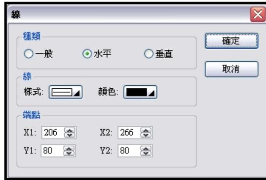
如欲改變水平線兩端的位置或直線長度，請先點選目標水平線再將滑鼠箭頭放在水平線任意一端之四方格上，等到滑鼠箭頭變成雙箭頭。按住滑鼠左鍵不放，並將其拖曳到工作區內任意位置。
